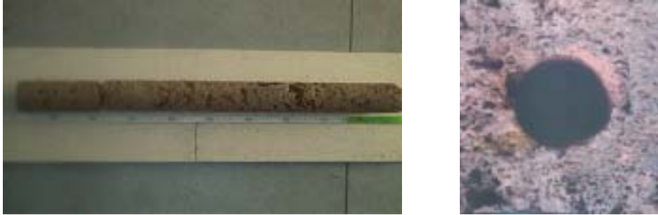
Fig. 12 - Esempio di carota e di foro di prelievo
