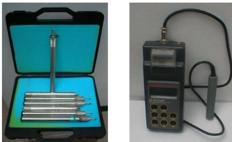
*Fig. 19 - Diver (a sinistra) e conducimetro con logger (a destra)*
